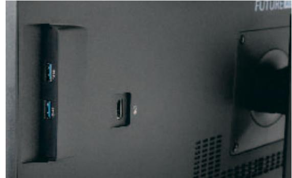
Rechts: Seitlich sind zwei USB-Ports, zum Beispiel für Tastatur und Maus, sowie ein HDMI-Ausgang angebracht.
